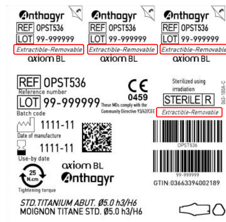
Voorbeeld van een etiket voor een standaard abutment Ø5.0, gingivale hoogte 3.5 en coronaire hoogte 6mm
